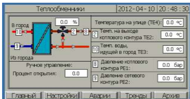
Рис. 4 Экран визуализации "Теплообменники"
