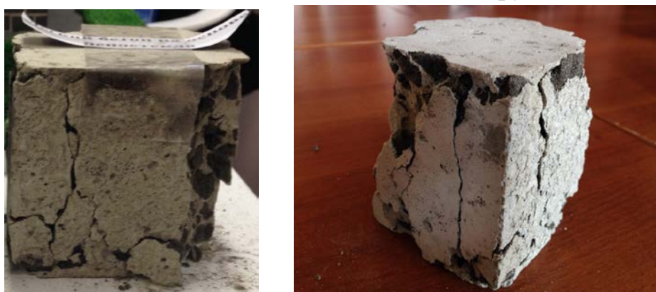
Рис. 2. Образцы легкого бетона, после испытаний на сжатие
