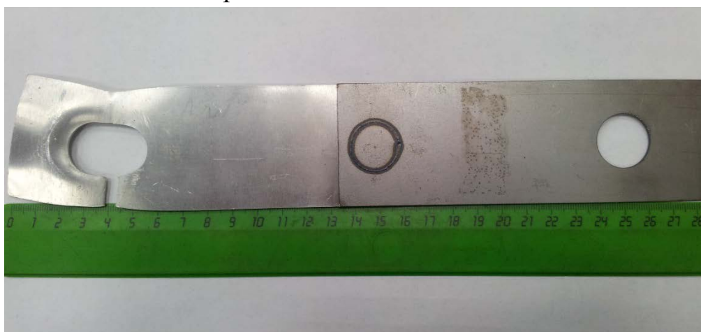
Рисунок 3 – Внешний вид образца АД1М + 08пс с толщинами 1,5 мм / 1,2 мм после физико-механических испытаний
