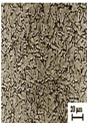
Ультрамелкозернистая структура материала, полученная способом равноканального углового прессования
