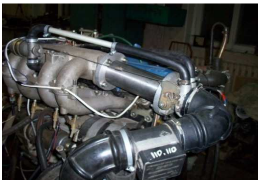
Рис.7. Общий вид двигателя с установленной модернизированной впускной системой
