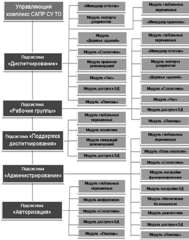
Рисунок 9 – Основные функциональные подсистемы комплекса УК-01
