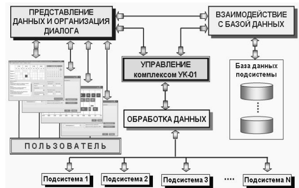
Рисунок 12 – Логика работы подсистемы программного комплекса УК-01
