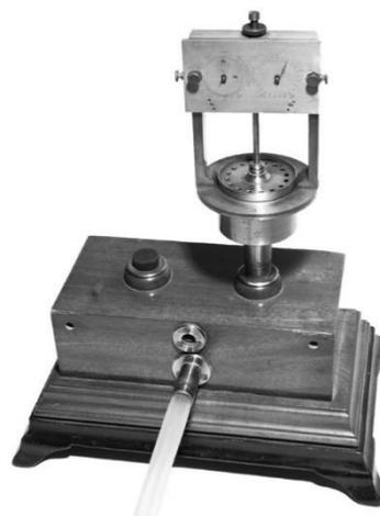
Рис. 6. Воздушный «поющий» гироскоп [14, с. 457]
