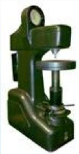
Твердомер предназначен для измерения твердости металлов и сплавов по методу Роквелла.
